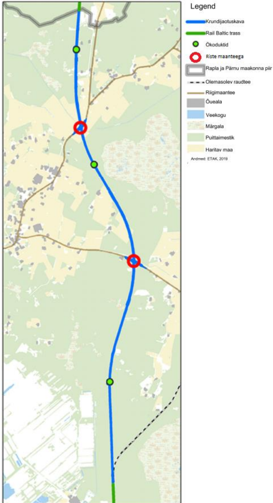
Joonis 6. Eelprojekti lahenduse järgne Rail Balticu trassi kulgemine (sinine ala on krundijaotuskava järgne maavajadus) ning eritasandiliste ristumiste ja ökoduktide asukohad
