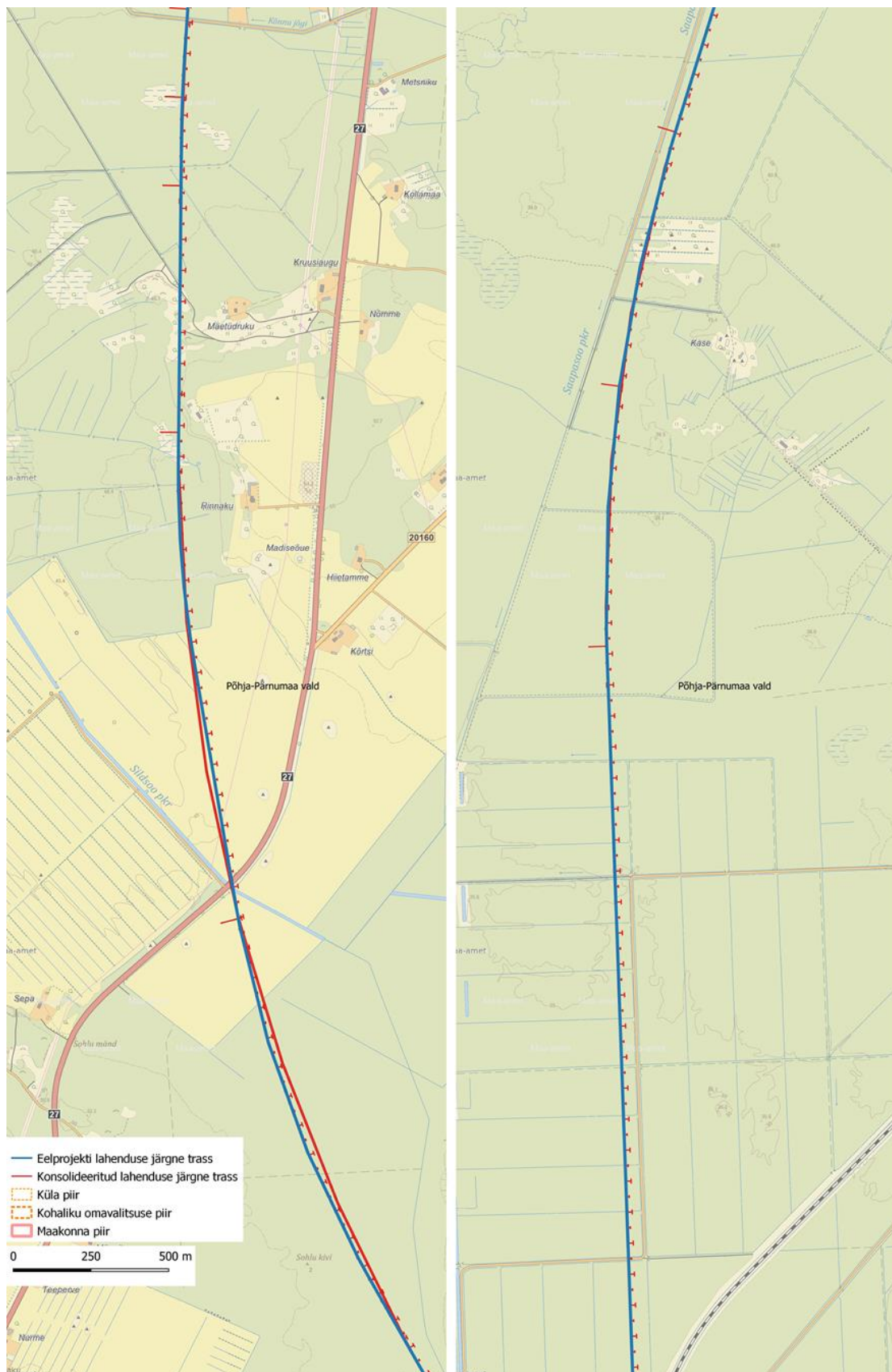
Joonis 10 Konsolideeritud eelprojekti ettepaneku järgne esialgne Rail Balticu trassi kulgemine (joonisel punasega) lõikudes, kus trassi telje paiknemine erineb eelprojekti lahendusest (joonisel sinisega)
